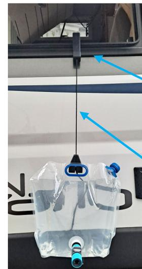
Abbildung a: Spezial-Kederhaken (9) eingehakt in die Kederleiste hält das Tragseil in Position
