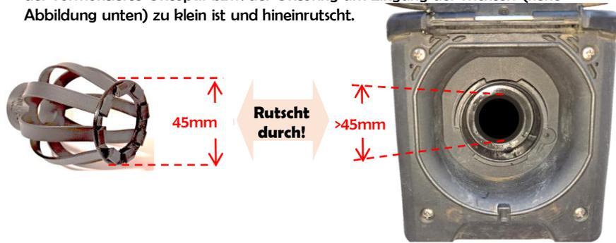
Du merkst das, wenn Du den Oktopus weiter hineinschieben kannst und der Ring vor dem eigentlichen Einfüllrohr nicht hängen bleibt.
