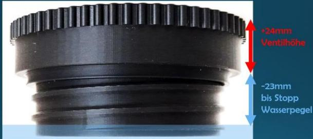
Dies ist ein Spezialdeckel des Watermanager Autofill CT. Er setzt das Ventil 36mm höher. Der Wasserstopp-Punkt ist ab Montagepunkt des Ventils bei -47mm. Der Wasserpegel wird also hier bei  $-47\text{mm} + 24\text{mm} = -23\text{mm}$  von der Wassertank-Oberseite gestoppt. **Achtung: Das ist bereits IM Schraubverschluss! Achte unbedingt auf die Dichtheit des Deckels und vermeide Wasseraustritt.**
