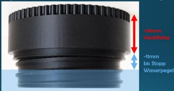
Dies ist ein Spezialdeckel des Watermanager Autofill CT. Er setzt das Ventil 36mm höher. Der Wasserstopp-Punkt ist ab Montagepunkt des Ventils bei -47mm. Der Wasserpegel wird also hier bei  $-47\text{mm} + 36\text{mm} = -11\text{mm}$  von der Wassertank-Oberseite gestoppt. **Achtung: Das ist bereits IM Schraubverschluss! Achte unbedingt auf die Dichtheit des Deckels und vermeide Wasseraustritt.**
